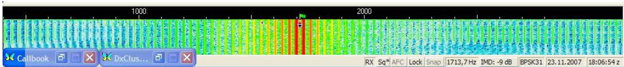
Slika 15: Premodulisani BPSK31 signal stvara smetnje po celom opsegu
