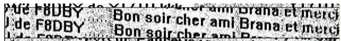
Slika 26: Predajna i prijemna stanica nisu potpuno sinhronizovane, pa je primljeni tekst iskošen, ali čitak
